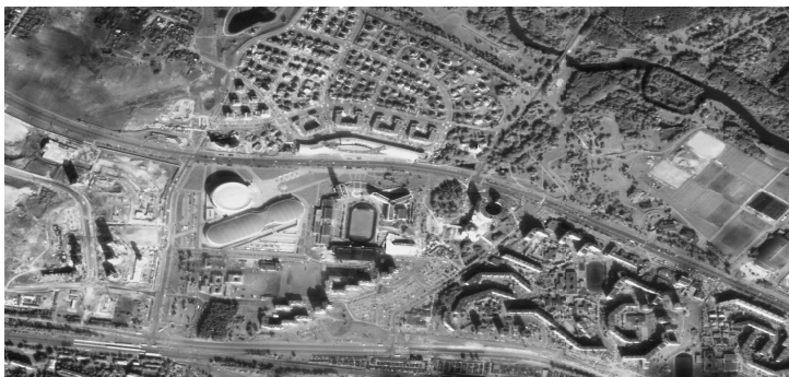
Рисунок 2.5. Данные дистанционного зондирования Земли с Белорусской космической системы, район Минск-Арена, разрешение 10,5 м в пикселе
