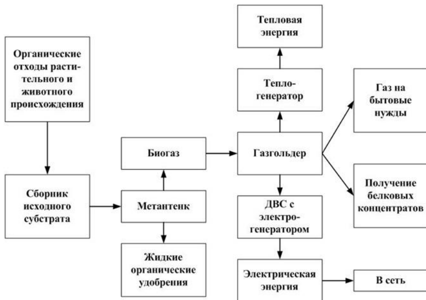
Рисунок 9.5.3.11. Принципиальная схема крупного биоэнергетического комплекса
