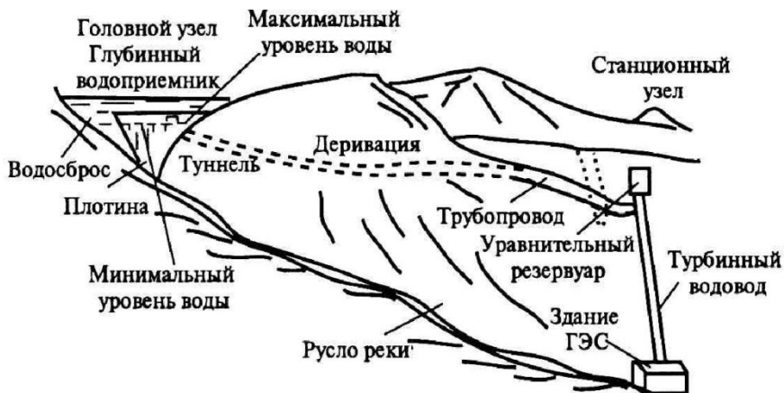
Рисунок 9.4.3.8. Схема сооружения ГЭС с напорной деривацией
