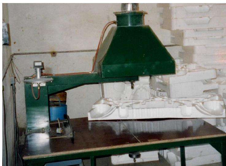
**Рисунок 3.8 – Установка для резки плитного пенополистирола – отхода основного производства**
