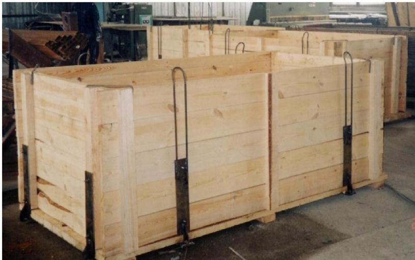
**Рисунок 3.11 – Деревянная кассета для формования полистиролбетонных плит**
