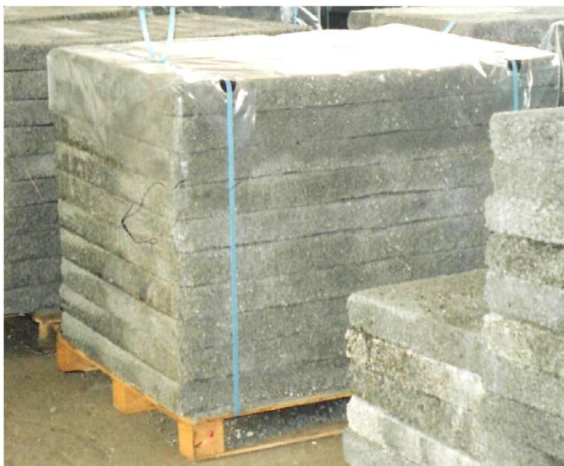
**Рисунок 3.12 – Складирование полистиролбетонных плит**
