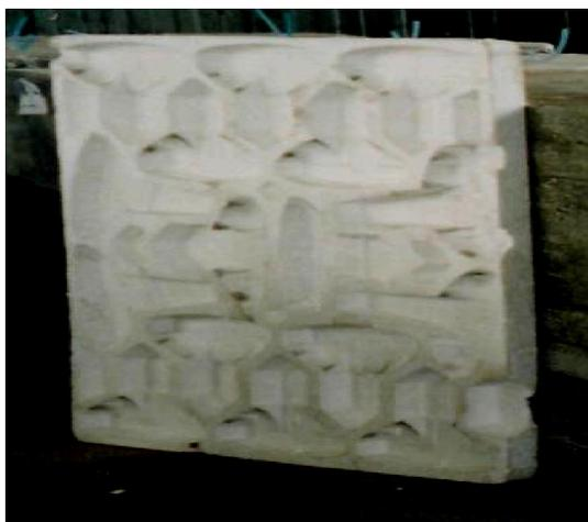
**Рисунок 3.8 – Пенополистирольный вкладыш**
