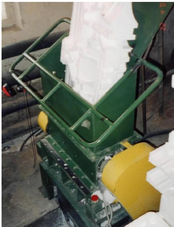
**Рисунок 3.9 – Дробилка пенополистирольных вкладышей**
