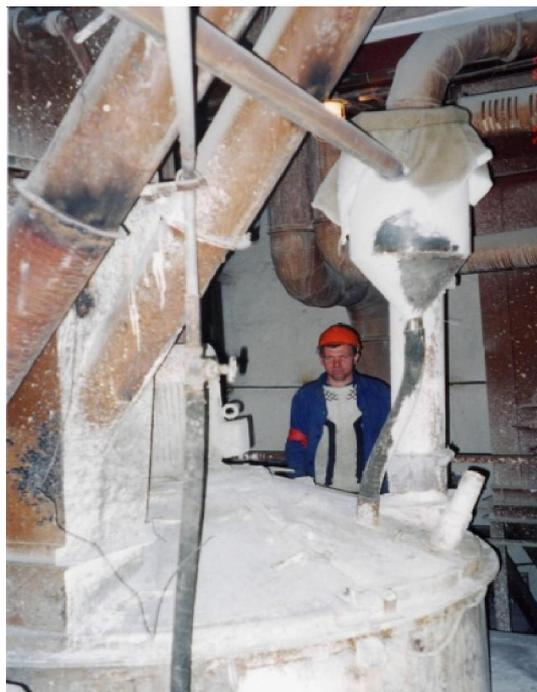
**Рисунок 3.10 – Бетоносмеситель**
