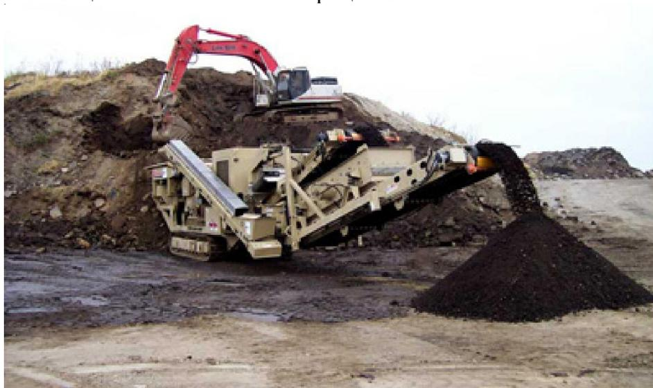
**Рисунок 3.3 – Мобильная дробильная установка**
