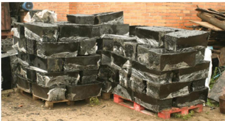
**Рисунок 3.6 – Чистый битум, полученный из отходов по технологии ПБМ**
