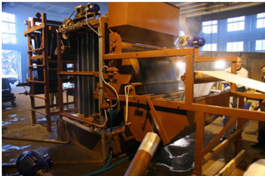
**Рисунок 3.7 – Линия по выработке современных битумно-полимерных наплавляемых материалов**
